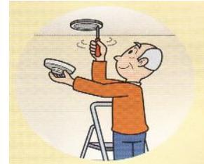
天井に設置する場合には、まず、取付ベースを本体からはずして取り付け、本体を設置する。
