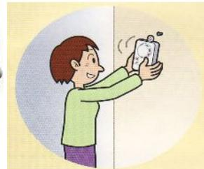
壁や柱に設置する場合には、天井と同様に取付ベースを取り付ける製品と、フックが付いていて、ネジ釘や釘で、取り付けられます。
