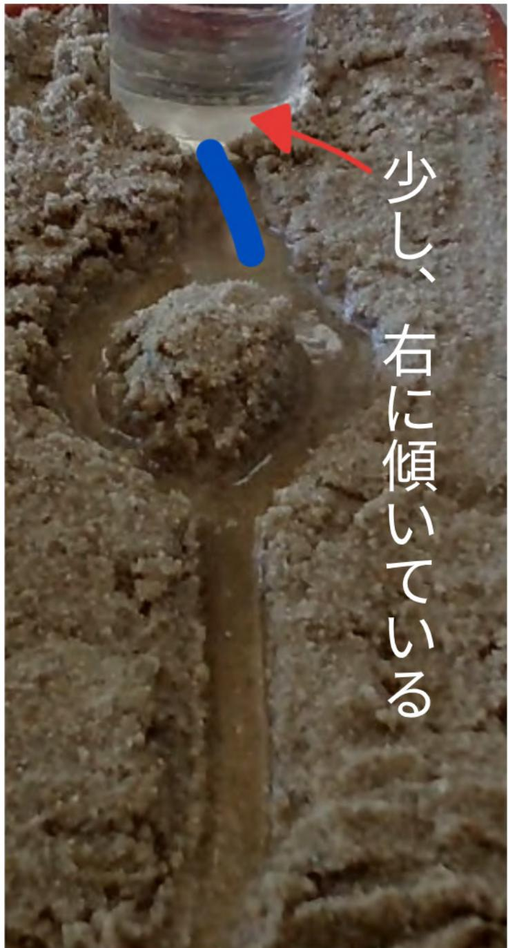
こちらの写真は、水が流れてすぐの実験の様子です。よく見ると、水の出るところが、右に少し傾いているのが分かります。なので、右側だけ大きく浸食したのは、実験のミスだと思います。
