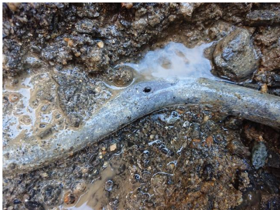
漏水修繕の際に鉛製給水管を取り替えています
