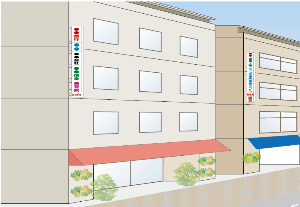
周辺のまちなみの連続性に配慮しつつ、突き出し幅を控えめにした例
