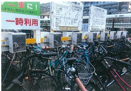
（※写真② 電磁ロック式個別ラックシステム）
