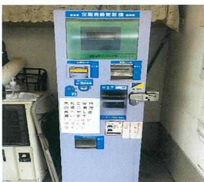
また、自転車駐車場管理の機械化を図る一つとして、定期更新機の導入を進めるもので、定期更新機の導入により、定期更新時の窓口混雑を軽減するとともに、管理員の窓口業務（現金のやり取り等）の負担軽減を図ります。
