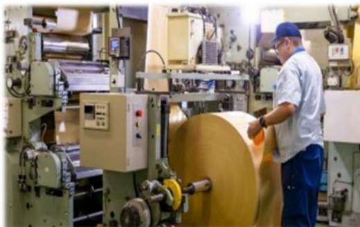
【一貫機】既製品の封筒は大きなロール紙から製造します
