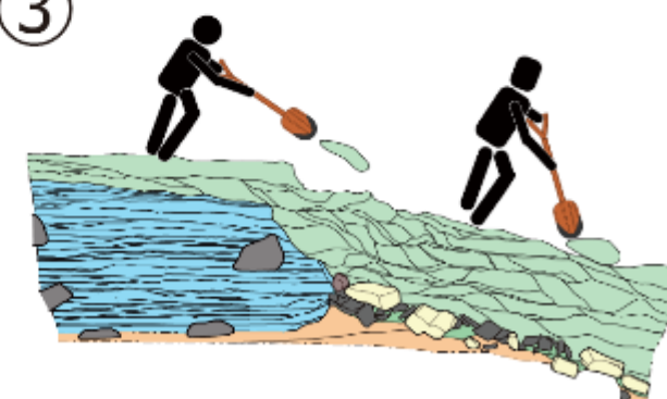
基壇を残置し、その上部に最大1.5m 盛土を行う
