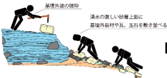
下層塔の解体、基壇外装の撤去・破碎 上層塔建設に向けた整地の開始 基底部の湧水対策
