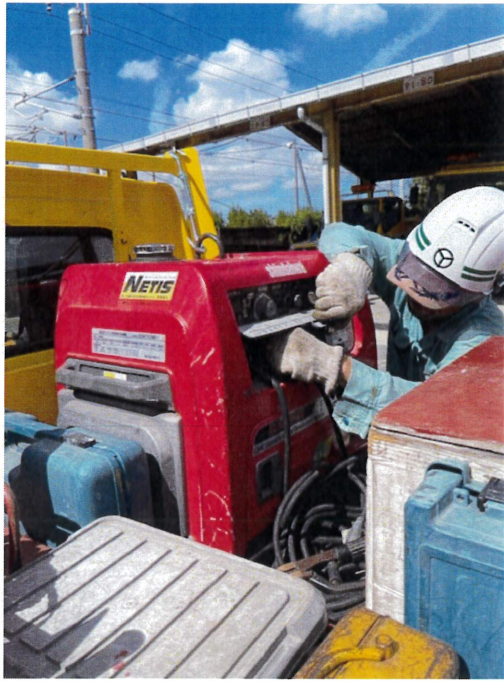
↑アーク溶接時 発電機兼用溶接機操作状況 ↑ (土木管理事務所内 作業ヤード)
