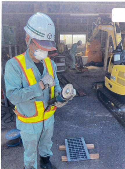
↑ 研磨といし（ディスクグラインダー）作業開始前試運転状況 ↑ (土木管理事務所内)
