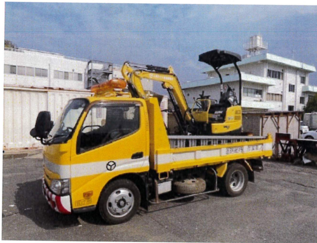
←バックホウ 回送積込状況 (土木管理事務所内)
