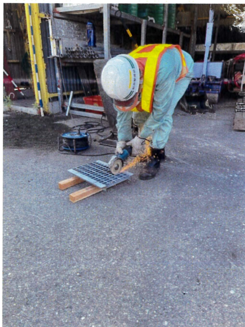
↑ 研磨といし（ディスクグラインダー）作業開始前試運転状況 ↑ (土木管理事務所内)
