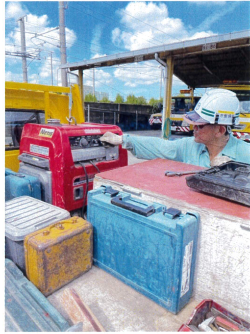
↑アーク溶接時 発電機兼用溶接機操作状況 ↑ (土木管理事務所内 作業ヤード)
