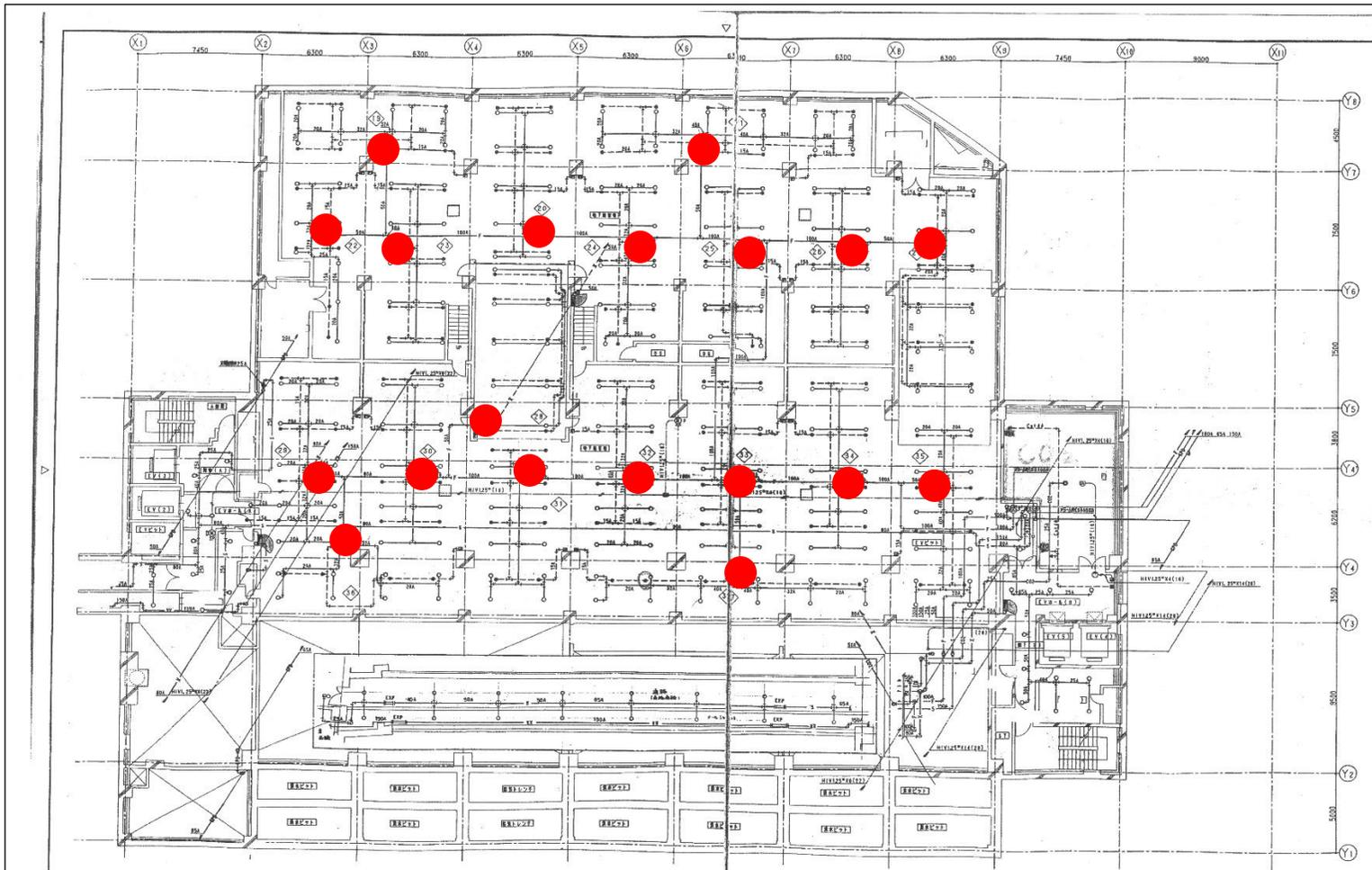
■ 消火設備図面(本館地下3階平面図)
