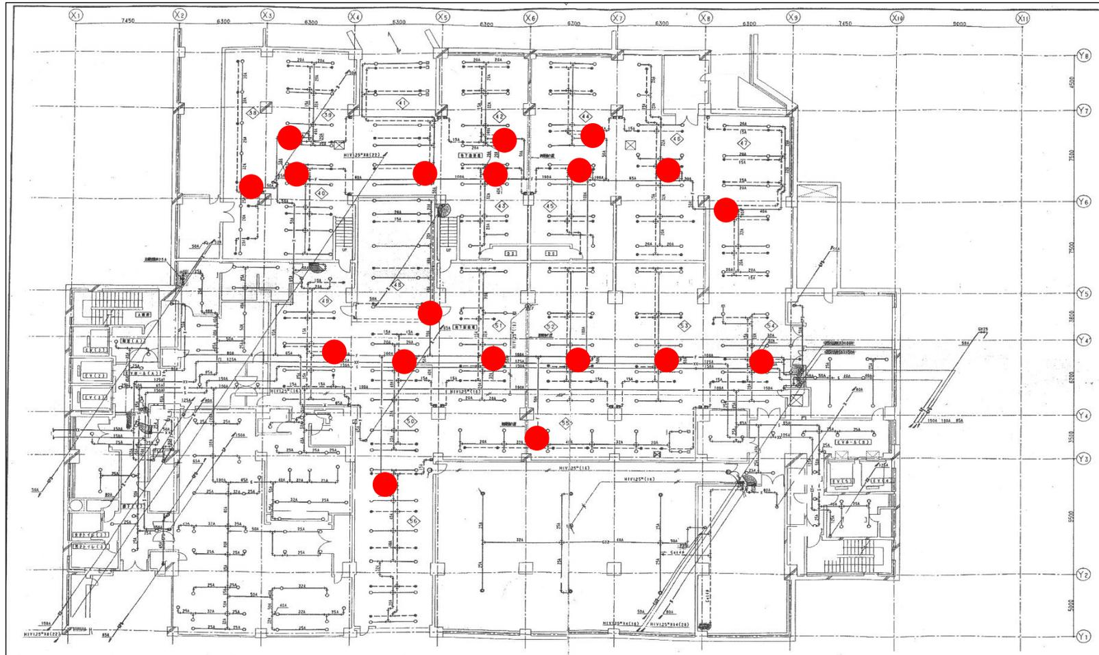
■ 消火設備図面(本館地下2階平面図)
