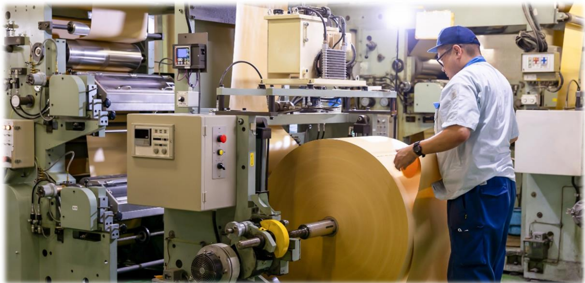
既製品の封筒は大きなロール紙から製造します
