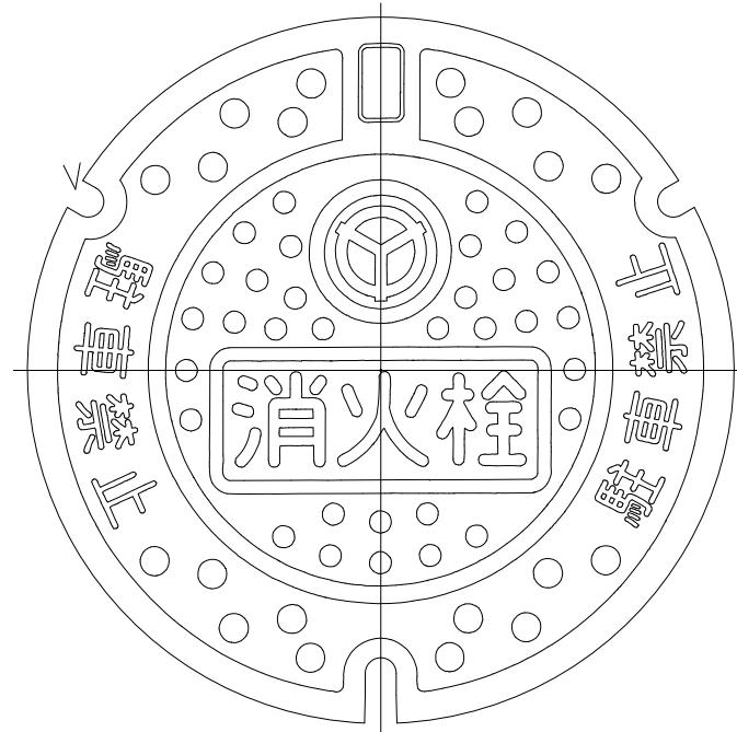
空気弁付消火栓鉄蓋 円形3号
